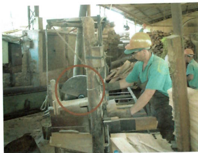
Fig. 33 – Destopadeira Pendular – Vista Lateral - Detalhe do protetor fixo para porção não cortante da serra
