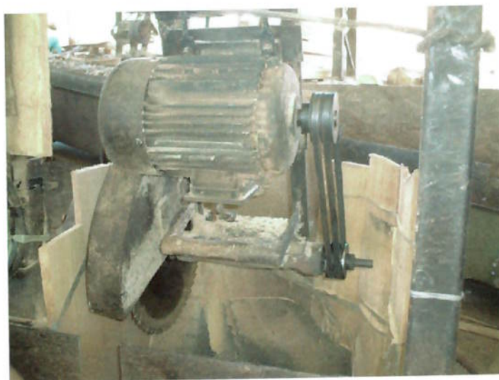
Fig. 45 – Proteção da serra – vista frontal
