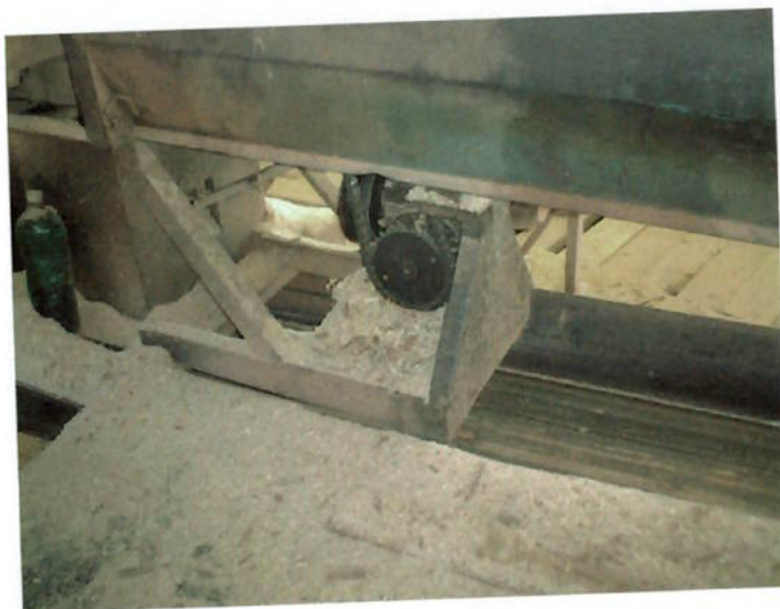
Fig. 29 – Engrenagem do avanço da refiladeira
